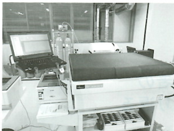
図5 パーキンエルマー社製 液体シンチレーションカウンターの概観
