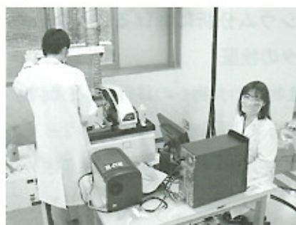
図4 パーキンエルマー社製 高周波誘導結合プラズマ質量分析装置 ELAN の概観
