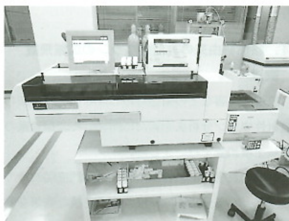
図1 パーキンエルマー社製 NaI (TI) シンチレーション型全自動多検体分析装置の概観
