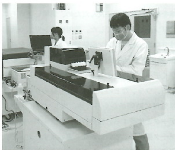
図2 NaI (TI) シンチレーション型全自動多検体分析装置の測定風景
